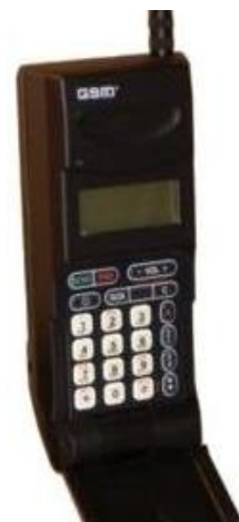
1er portable en France Codage numérique de la voix Repérage cellulaire de la position du téléphone (réseau GSM) 1992
